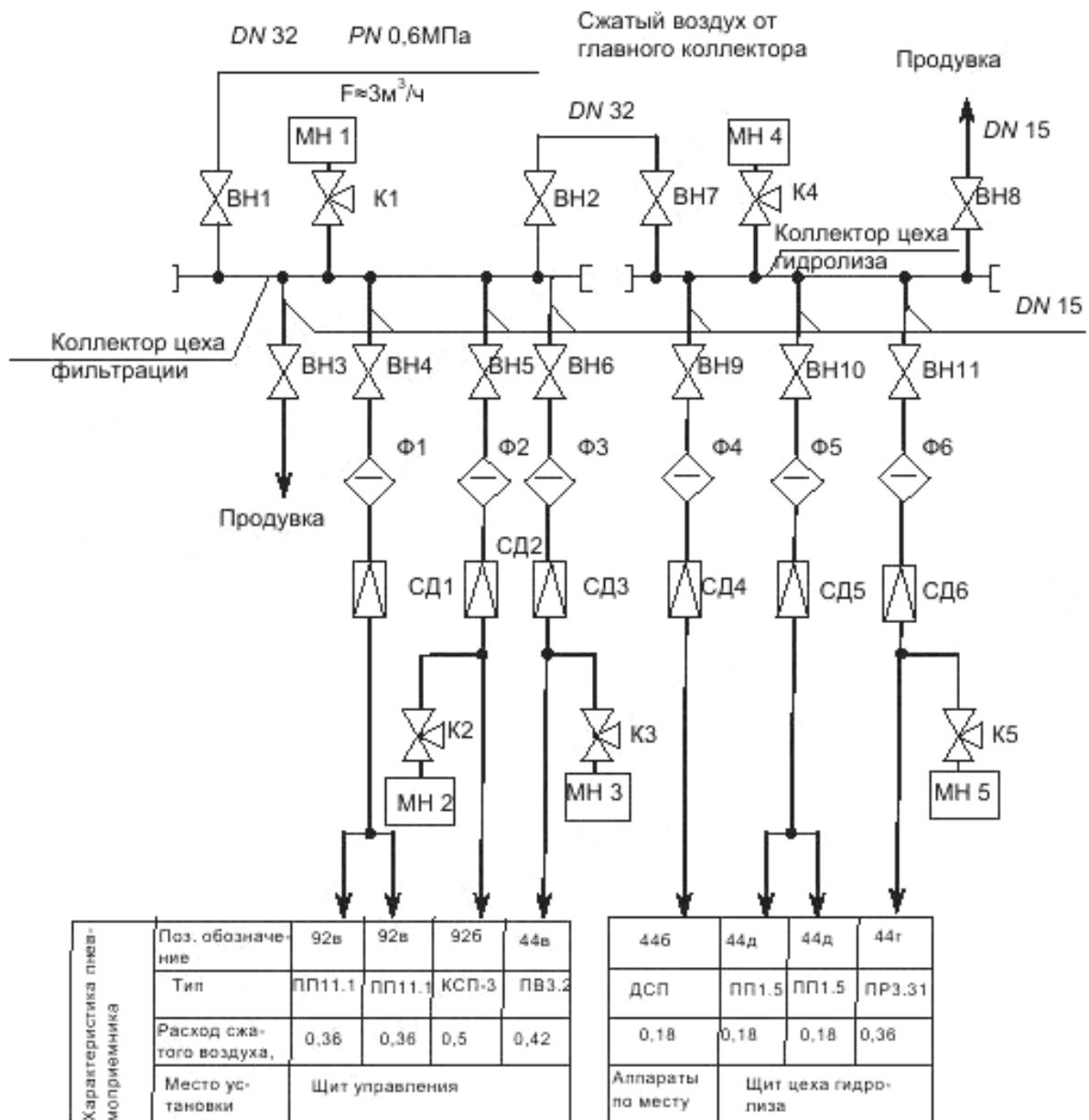
Рисунок Е.2 — Пример выполнения принципиальной схемы пневматопитания
