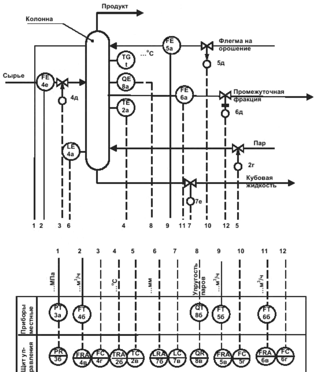
Рисунок В.1 — Пример выполнения схемы автоматизации развернутым способом
